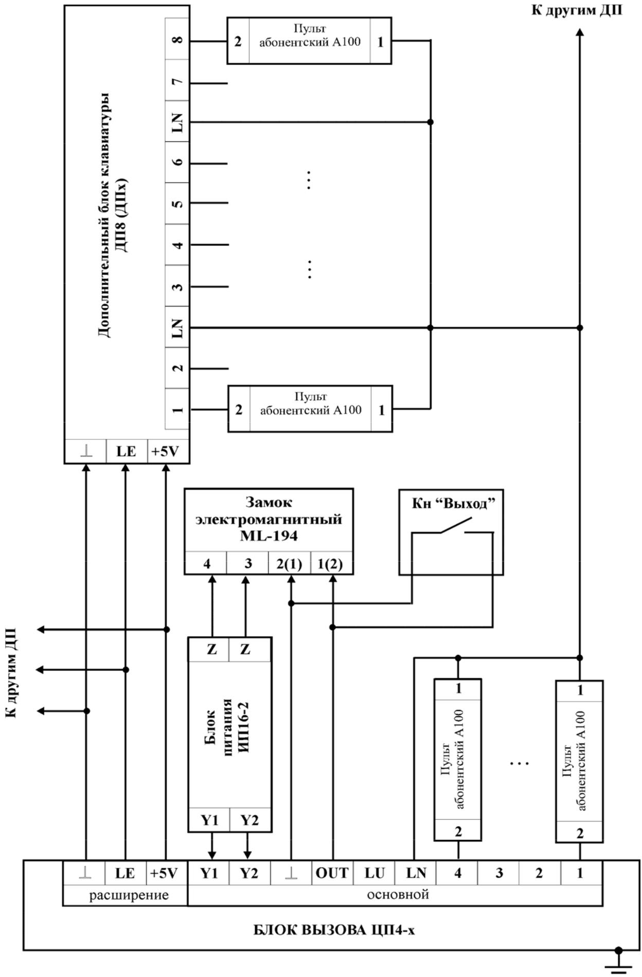
**МОНТАЖНАЯ СХЕМА СОЕДИНЕНИЯ БЛОКОВ ДОМОФОНОВ С ИСПОЛЬЗОВАНИЕМ ПУЛЬТА КОНСЬЕРЖА**
